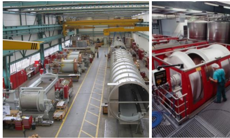
Fruchtsaft-, Bierfiltrations- und Trocknungsanlagen
