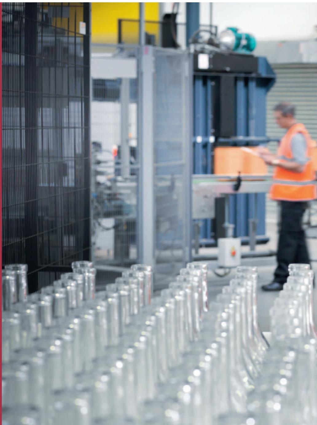
Das neue, patentierte Härtingsverfahren revolutioniert Glas als Verpackungsmaterial. Dabei werden die Glasbehälter auf die Härtingstemperatur von knapp 700°C erhitzt und im Anschluss über eine Vorrichtung innen und aussen schnell und gleichmäßig abgekühlt. Dies führt im Glas zu definierten mechanischen Spannungen, welche die Festigkeit des Behälters erhöhen – was erlaubt, das Gewicht des Behälters zu reduzieren. Eine klassische 1-Liter-Mehrwegflasche wiegt statt
