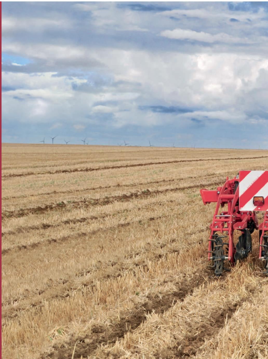
Mit dem Strip-Till-Verfahren leistet Kuhn Group in Europa Pionierarbeit. Nach der Lockerung und gleichzeitigen Düngung der Bodenstreifen können diese, einmal abgetrocknet und erwärmt, im zweiten und bereits letzten Durchgang besät werden. Die Bodenbearbeitung und die Aussaat sind dadurch mit weniger Energie- und Zeitaufwand verbunden und erreichen in manchen Fällen höhere Ernteerträge.
